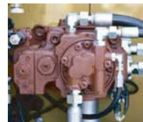
Sistema hidráulico, banco de válvulas y motor de giro original Kawasaki.
