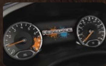
Clúster premium con pantalla TFT a color de 7" configurable
