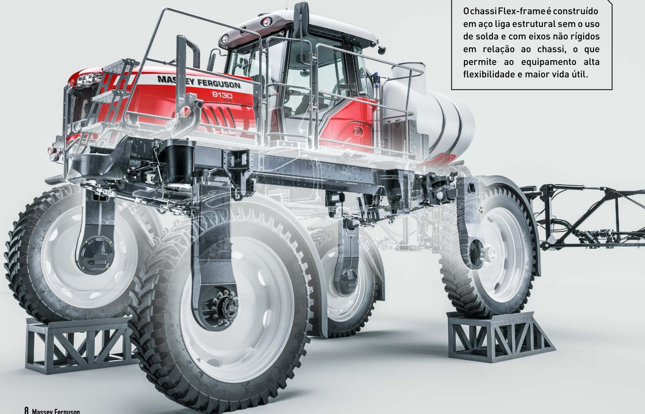
O chassi Flex-frame é construído em aço liga estrutural sem o uso de solda e com eixos não rígidos em relação ao chassi, o que permite ao equipamento alta flexibilidade e maior vida útil.
