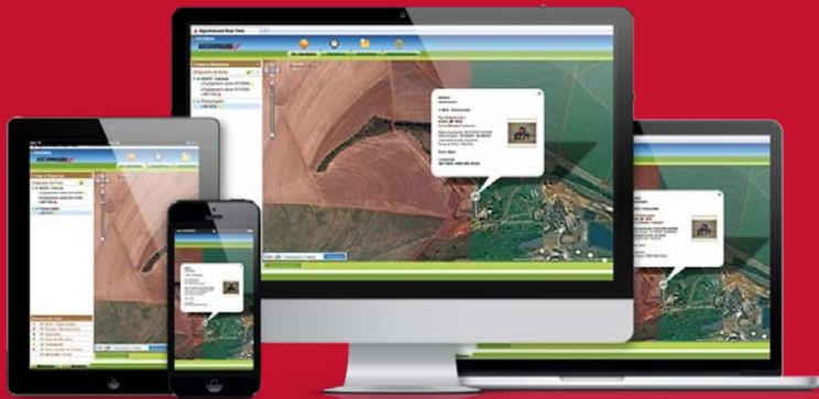
Sistema de telemetria que monitora cada colheitadeira e a posição das máquinas 24 horas por dia, para possibilitar o gerenciamento do desempenho, da produtividade e da manutenção.
