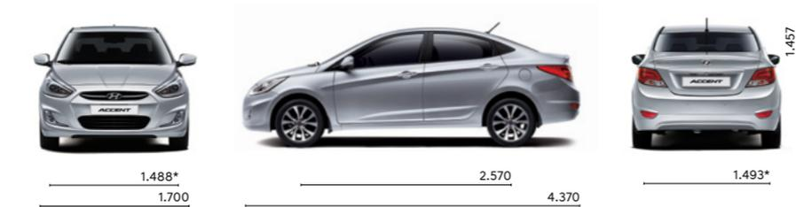
\* Banda de rodadura de las ruedas • 14" (Delantera / trasera): 1.506 / 1.511 • 16" (Delantera / trasera): 1.488 / 1.493
